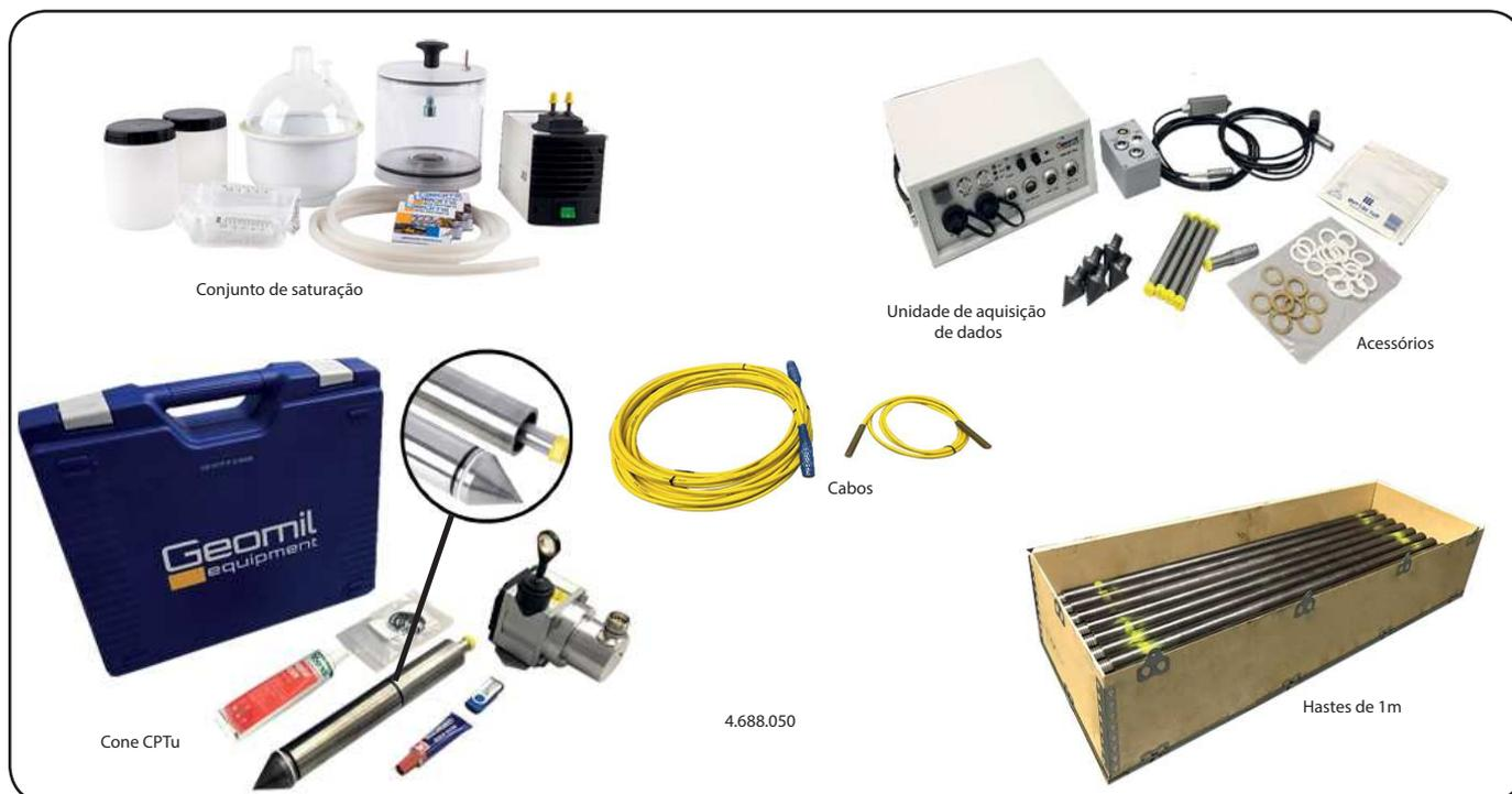
**Cone elétrico CPTU para Determinação de Propriedades de Cravação de Solo** com este equipamento pode-se obter resistência de ponta, atrito lateral e poro-pressão de solos. O conjunto não acompanha o penetrômetro nem a bomba hidráulica, necessárias a cravação. Acompanha um cone com 10cm<sup>2</sup> de área, hastes para até 30 metros, cabos, sistema de aquisição de dados e software. Acompanha também um kit de saturação dos discos porosos. Procedência Holandesa.
