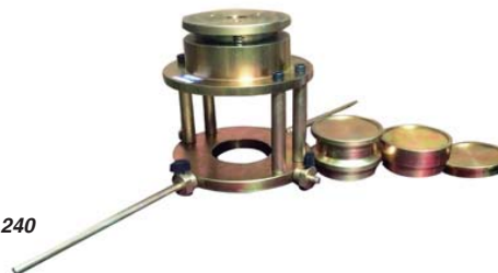
1.108.510 - Dispositivo de Rilem para romper argamassa
