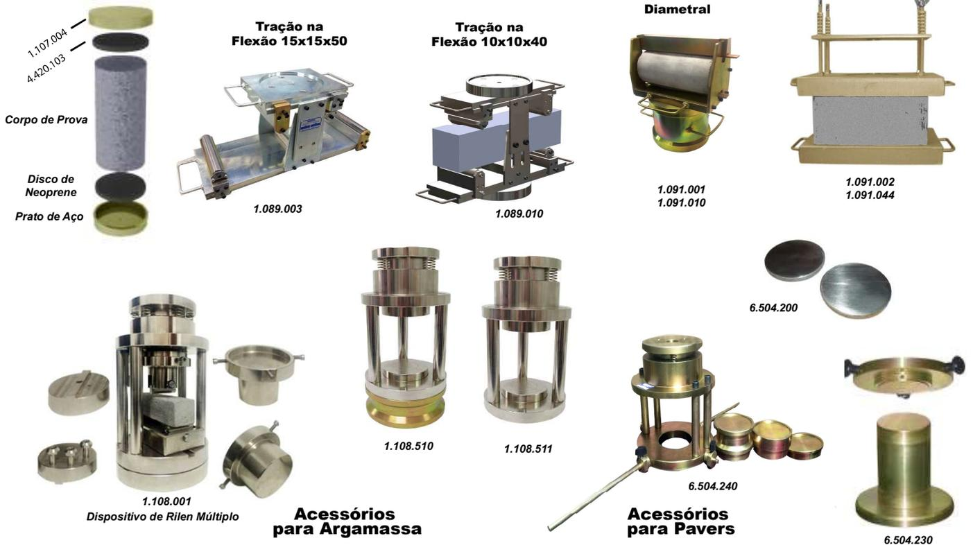
**Disco de neoprene** com dureza de 70 shore, para regularizar imperfeições dos corpos de prova de concreto e argamassa sem a necessidade de capeamento.
