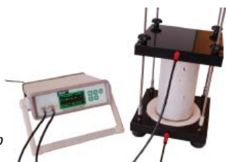
4.851.030 - Medidor de Resistividade e Temperatura em Amostras de Concreto Fresco
