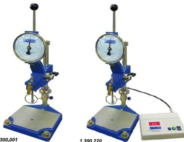
**Penetrômetro Universal** com curso de 40mm e subdivisão de 0,1mm. Possui dispositivo para soltar a agulha sem contato manual, com pouco atrito. É dotado ainda de coluna regulável, base reforçada perpendicular usinada em ferro fundido, nível de bolha e espelho para auxiliar a visualização da agulha.
