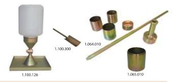
Conjunto para Determinação da Densidade "In situ" (Cone de Áreia) Compostos por bandeja, frasco e funil com registro Ø5" e Ø6" para so**l**os e Ø8" ou Ø10" para brita.
