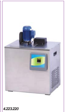
Medidor de Recuperação Elástica do Asfalto (torção) NLT 329/91 (Espanha)
